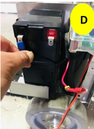
Après avoir connecté la cosse **bleu** du moteur à la cosse **noir** de la batterie, on va mettre en contact la cosse **rouge** du moteur à la cosse **rouge** de la batterie.
